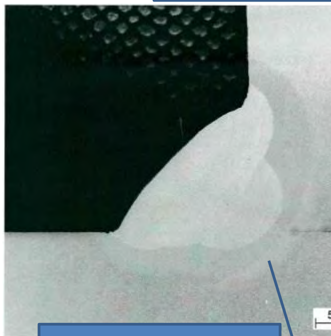
Makrostruktura svarové oblasti
