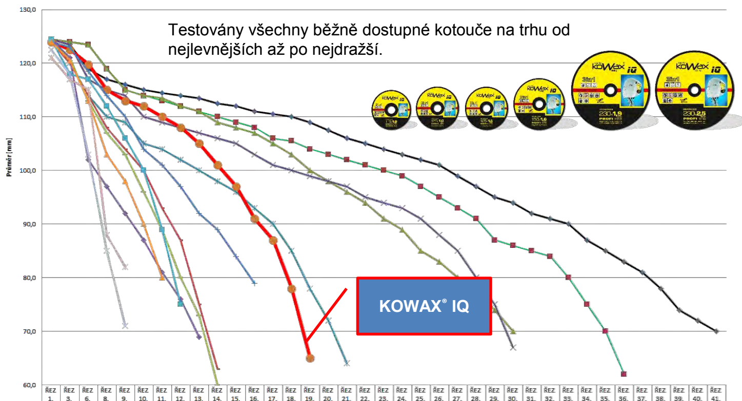
Porovnání řezných kotoučů 125x1,0mm na Oceli S235 40x10mm
