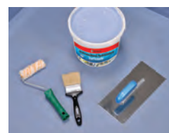
Připrava nářadí - váleček na disperze, štětec nebo ocelové hladítko.
