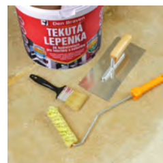
08 - Příprava nářadí - váleček na disperze, štětec nebo ocelové hladítko.
