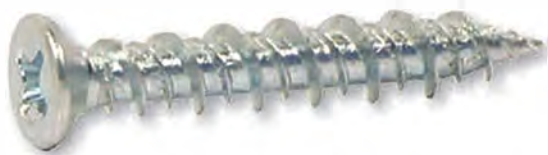
Vrut do kování - opravný, galvanický zinek bílý, min 5µm.
