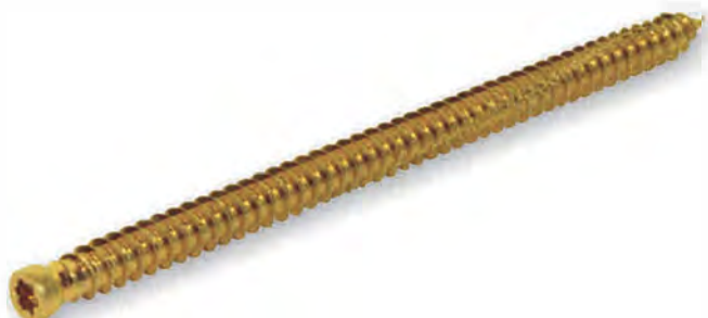
Okenní montážní šroub Turbo válcová hlava, žlutý zinek min. 5µm
