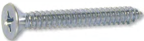
Vrut do plechu DIN 7982C galvanický zinek bílý min 3µm.
