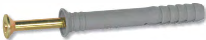
Natloukací hmoždinka STANDARD- zápustná Nylon + ocelový hřeb - žlutý zinek alternativně nerezový hřeb A2
