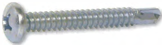
Vrtací vrut - DIN 7504N, galvanický zinek bílý min 3µm.
