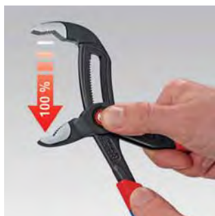
Stisknout knoflík – kompletně otevřít kleště
