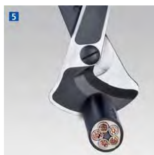
Opakujte řez a rozevření, až je kabel přeštrpnutý.
