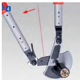
Po prvním dílčím řezu rozevřete ramena pomocí rohatky.
