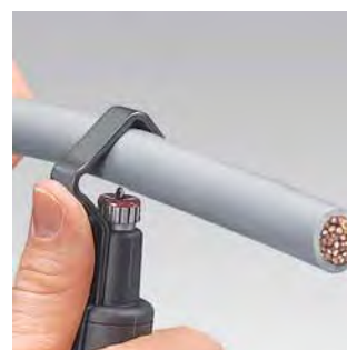
Nastavení nástroje pro obvodový řez
