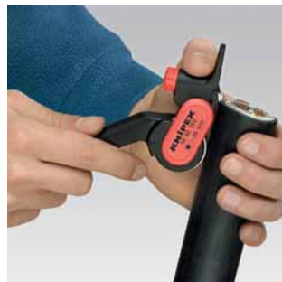
Nasazení nářadí pro odštíření v podélném směru
