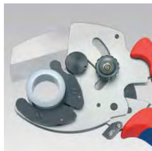
Čisté stříhání silnostěnných umělohmotných a spojovacích trubek
