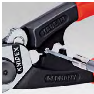
Nalisování koncové dutinky na tažné lano
