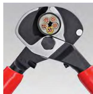
Velká kapacita: max. Ø 27 mm / 150 mm 2
