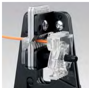
Čisté naříznutí izolace po celém obvodu
