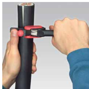
Otáčení nástroje pro obvodový řez
