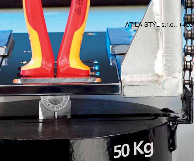
Zkouška přilnavosti izolovaných rukojetí s 500 N.
