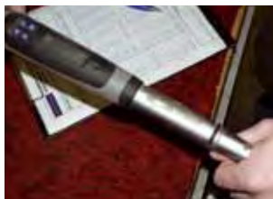
Měření krouticího momentu do zlomu
