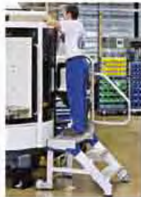
Pojízdná podesta pro montážní práce na strojních zařízeních.
