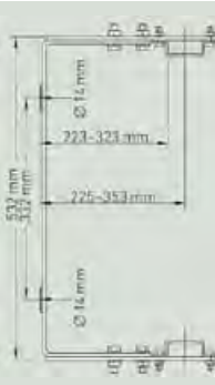
Kotva do zdi U, přestavitelná s přestavitelným odstupem od stěny 250 až 300 mm.
