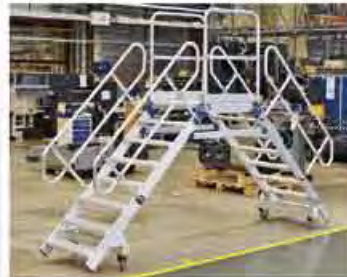
Pojízdný přechod jako pracovní plošina nebo jako přemostění nad překážkami.
