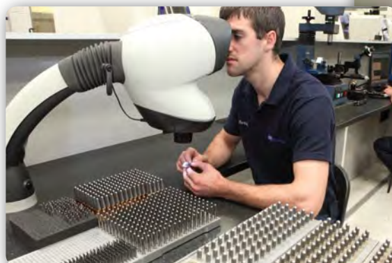
Kontrolle jedes einzelnen Frässtiftes Controlling each individual burr
